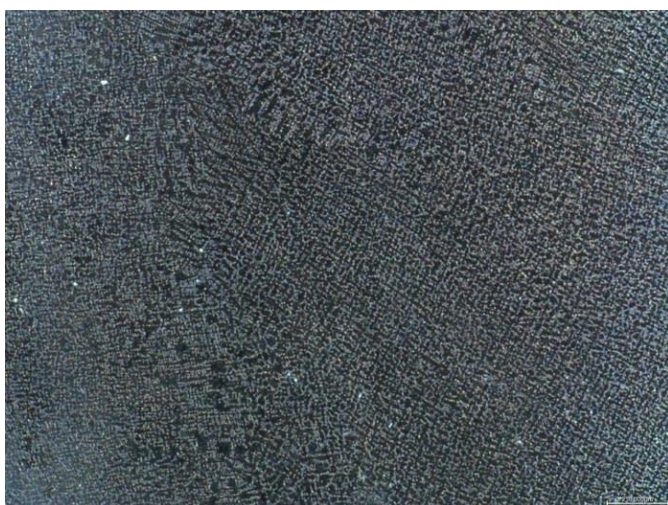
Рисунок 5.7 – Микроструктура упрочненной поверхности френча в плоскости, параллельной оси вращения образца, сплав ЭИ868
