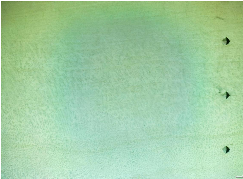
Рисунок Г.2 – Комбинированная микроструктура 6 слоя образца, упрочненного при 400^{\circ}\text{C} слоя из стали 309LSi, \times 157
