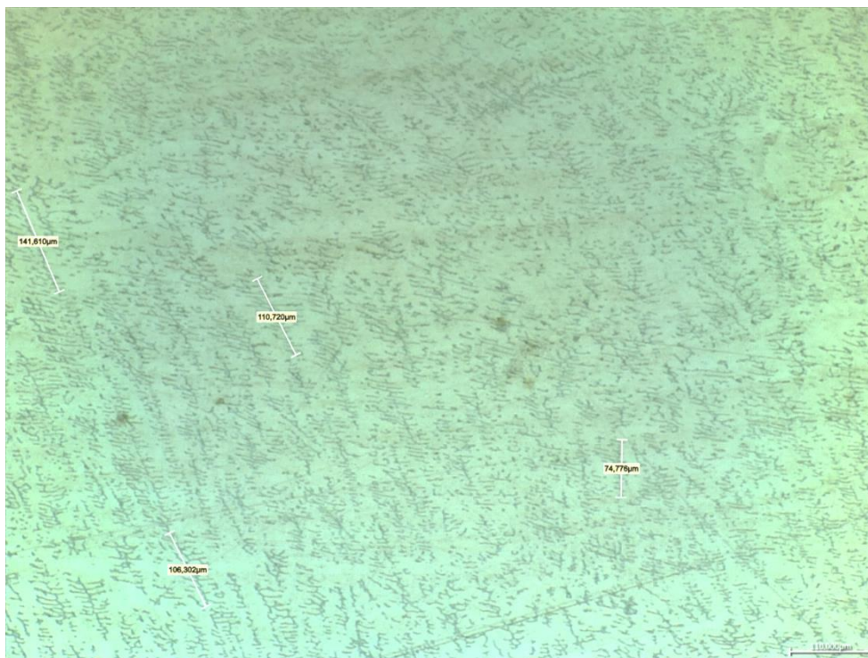
Рисунок Г.3 – Микроструктура верхней части 6 слоя образца, упрочненного при 400 °С слоя из стали 309LSi, x400
