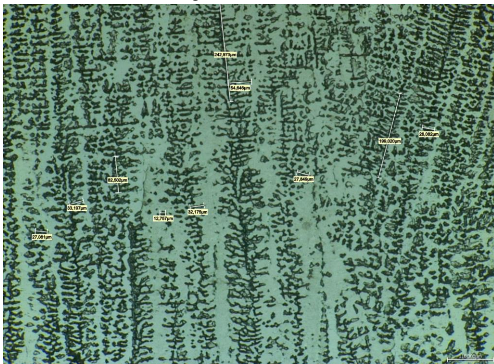
Рисунок Е.2 – Структура верхнего 10 слоя образца из стали 309LSi, с упрочнением каждого 5 слоя при 600^{\circ}\text{C} , \times 400
